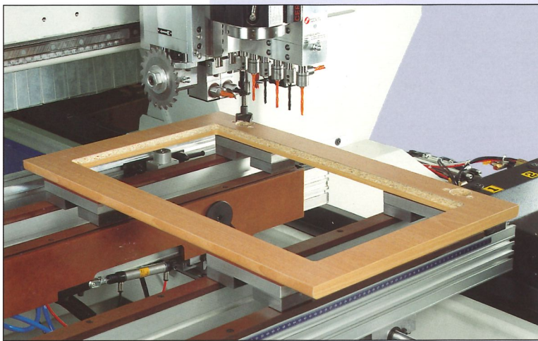
Lavorazione antine sfinatestrate. Sash machining. Fronten mit Glasausschnitt.
