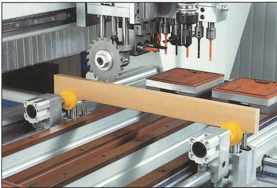
Bloccaggio pezzi stretti (opt.). Narrow pieces clamping device (opt.). Schmalteilstspannvorrichtung (opt.).
